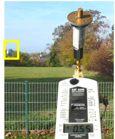
Messung, Nähe Kindergarten, HF 59B Leistungsflussdichte 550 \mu\text{W}/\text{m}^2
